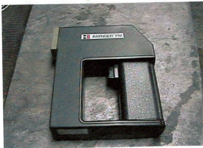
Figura 47 – Foto do sistema infravermelho do tipo radiômetro marca “RAYEC” modelo “Raynger PM” para leitura até 700°C (medidor para verificar temperatura do vidro e da esteira no momento da entrada no forno de recozimento)
