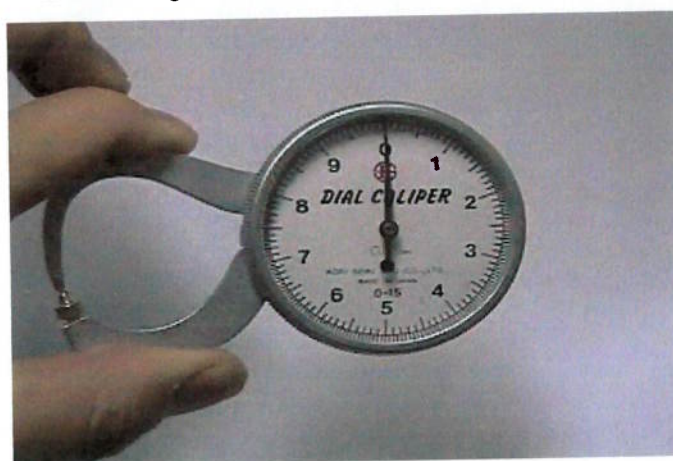
Figura 40 – Foto do medidor de espessura marca “KOEI SEIKI” para medições até 15mm.
