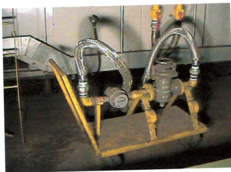
Figura 51 – Foto do medidor de vazão instalado para leitura do consumo de gás natural.
