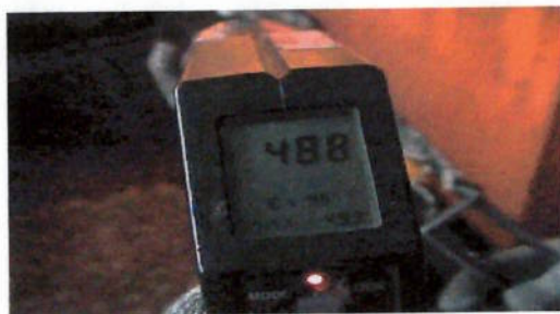
Figura 41 – Foto da leitura da temperatura do vidro antes de entrar no forno de recozimento utilizando um sistema infravermelho do tipo radiômetro com emissividade de 0,85.
